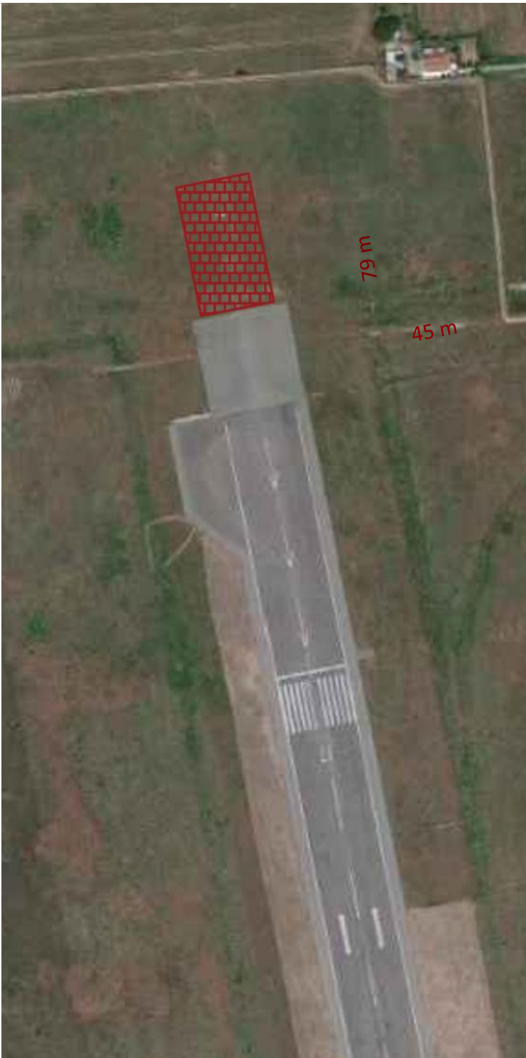
Figura 17 – Realizzazione EMAS (45 X 79 metri) a fine pista 35
