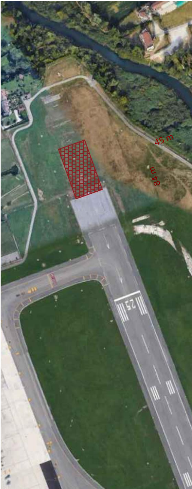
Figura 14 – Realizzazione EMAS (45 X 84 metri) a fine pista 07
